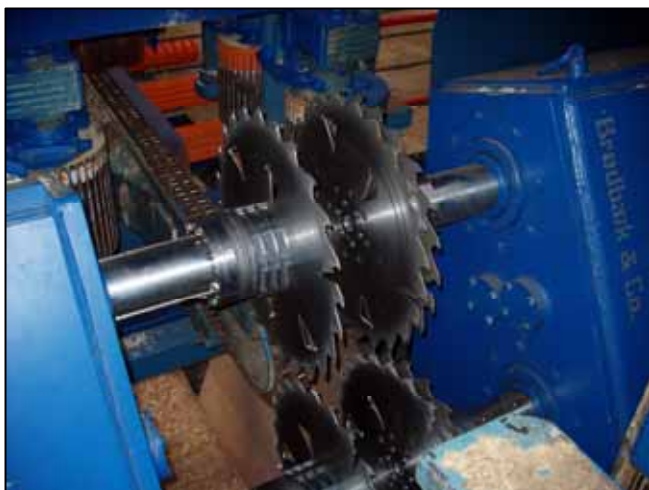
Die Doppelwellenkreissäge BCO 3-400
