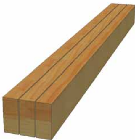
Optimierte Hauptware nach dem Profilspaner und der Säge
