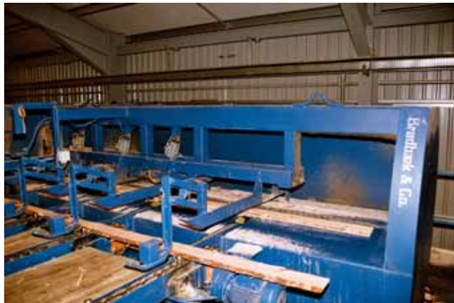
BCO 800/60 mit obenliegender Sägewelle
