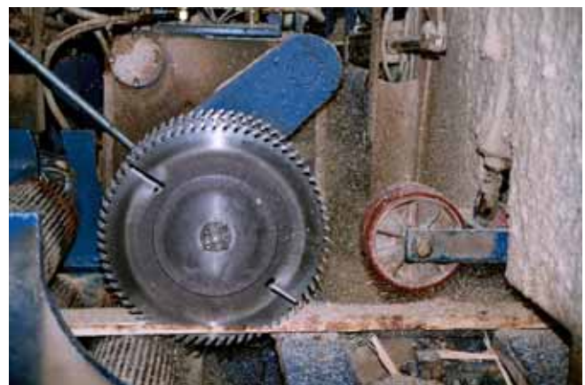
BCO 800/60 mit obenliegender Sägewelle
